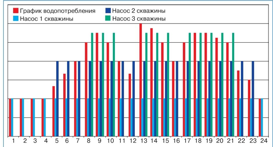
■ Рис. 2. Суточный график нагрузки насоса 1-й скважины
